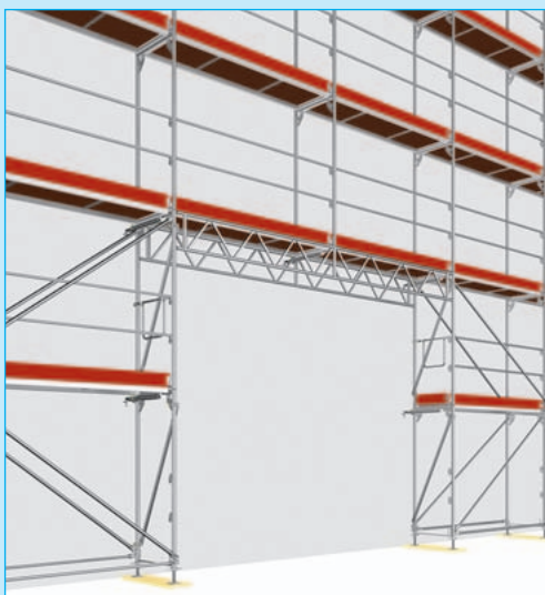
Пример: Ферма 5,14 м под двумя пролетами (специальная усиление диагоналями).
