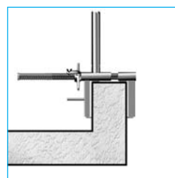
Установка на выступе.
