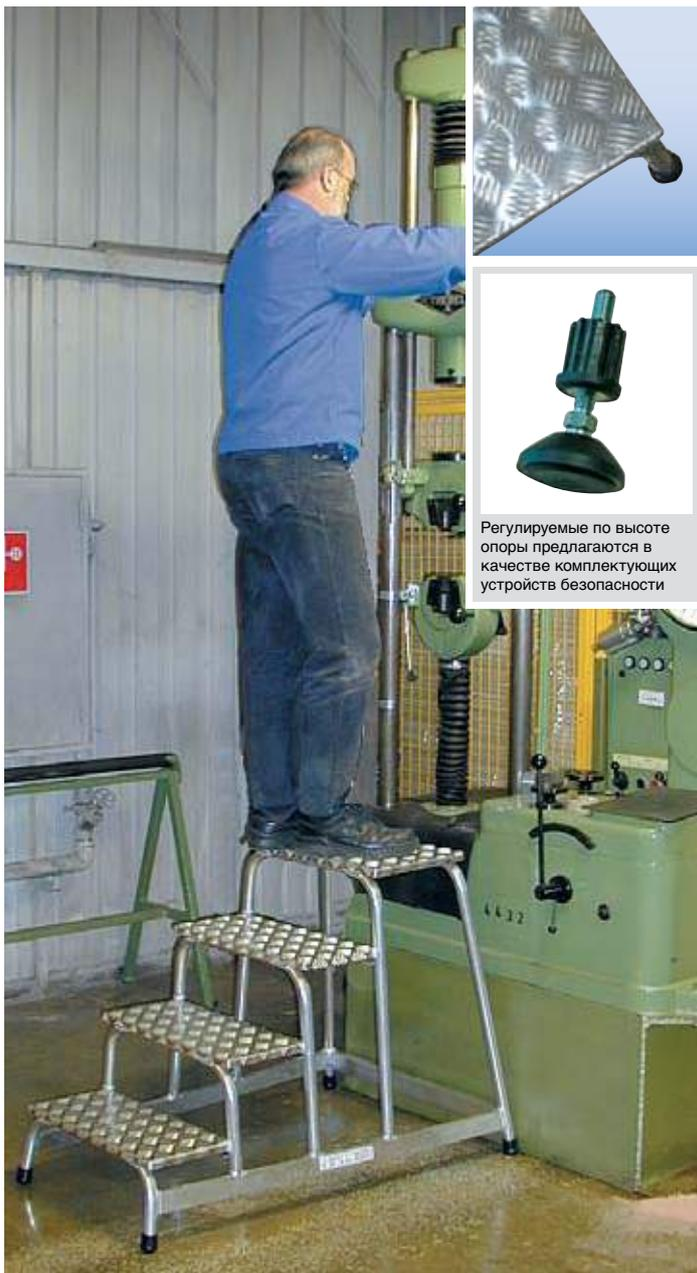
Регулируемые по высоте опоры предлагаются в качестве комплектующих устройств безопасности
