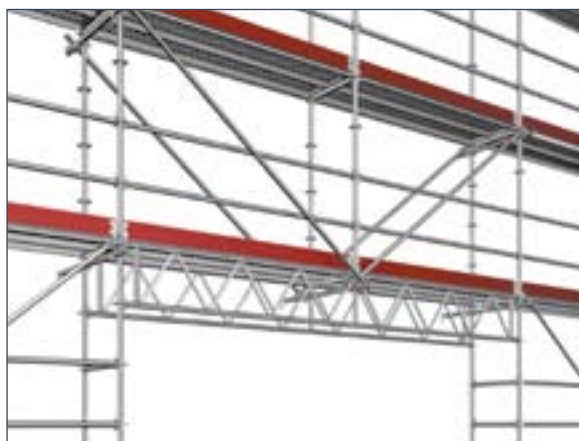
Пример монтажа: наконечник и U-образный ригель
